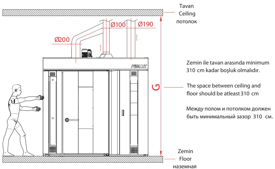
Zemin ile tavan arasında minimum 310 cm kadar boşluk olmalıdır.
