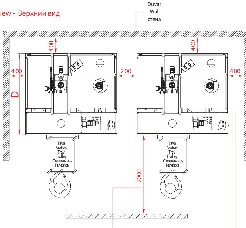
Fırın ile duvar arasında en az 200cm kadar boşluk olmalıdır.
